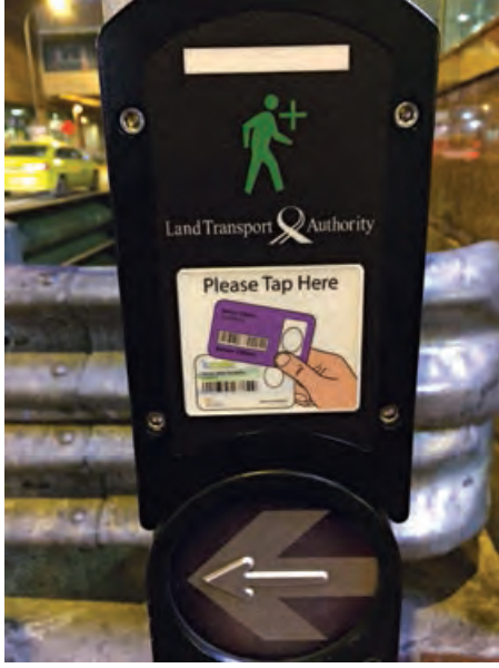
Resim 4. Engelliler ve yaşlıların kent içi erişilebilirliğini sağlamak için trafik ışığı süre kontrol paneli, Singapur. Fig. 4. Traffic light period control panel for the aid of the disabled and elderly, Singapore.
